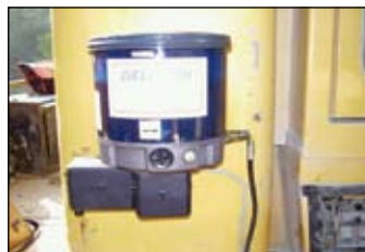
Obr. 10 Detail 24V DC mazacího přístroje
